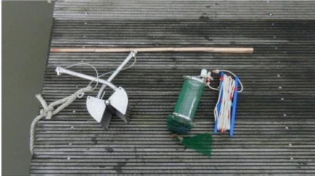
Abb.2: Der Sedimentgreifer (l.) und der Wasserprobenentnehmer für unterschiedliche Wassertiefen (r.)
