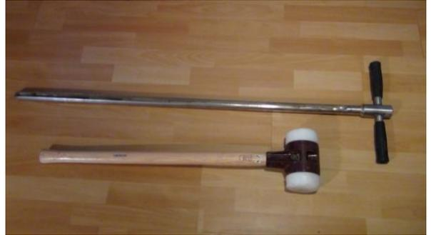
Abb.3: Der Pürckhauer Bodenprober (oben) und der Schonhammer (unten)
